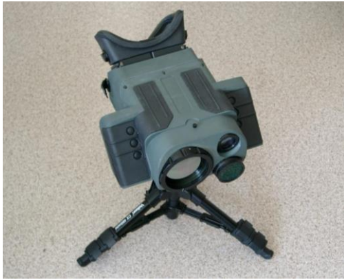
Рисунок 4 – Макетный образец двухканального прибора наблюдения
