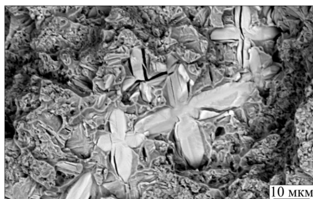
Рисунок 6 – Поверхности разрушения материалов, сформированных по технологии ВЭЛН порошковой смеси самофлюсующегося сплава, ниобия и бора: а – ПН77 + 30 % ( Nb – B ), б – ПН77 + 40 % ( Nb – B )
