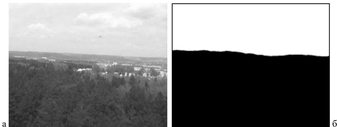
Рисунок 5 – Пример результата сегментации полутонового изображения (а) на области, занятые лесом и небом (б), с использованием значений векторов морфологических спектров в наборе текстурных признаков для различения областей
