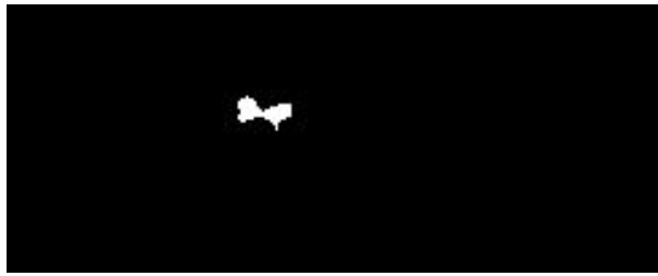
Рисунок 3 – Пример результата обнаружения движения дымового облака ( N_{кр} = 20 , k_{кр} = 7 )
