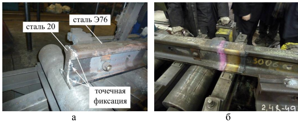
Рисунок 22 – Барьерная пластина из низкоуглеродистой стали, закрепленная на рельсовой заготовке (а), и полученная конструкция (б)
