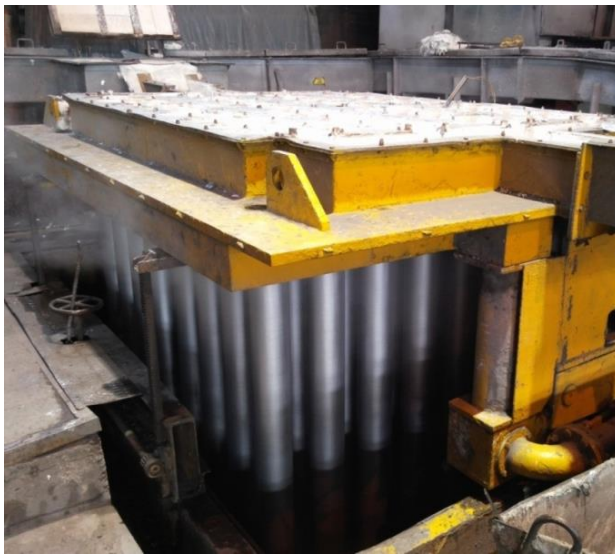
а б Рисунок 1 – Многоручьевой литейный комплекс (а) и эскиз кристаллизатора – ЭМП (б)
