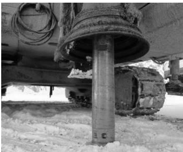
Рисунок 31 – Пневмоударник ПВ 170М, установленный на буровом станке SWDB165
