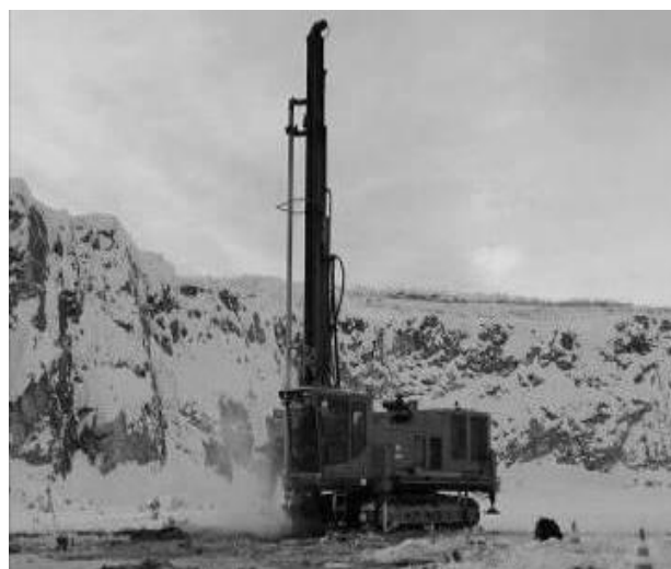
Рисунок 31 – Пневмоударник ПВ 170М, установленный на буровом станке SWDB165
