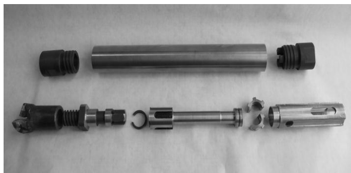
Рисунок 13 – Конструкция малогабаритного погружного пневмоударника АШ43Т
